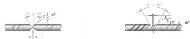
DETALLE DE SOLDADURA EN VARILLAS CON DIÁMETROS MAYORES QUE 1"
